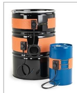
HSSD-Fassheizmanschetten sind besonders dafür geeignet, Gefrorenes anzutauen oder andere Produkte anzuschmelzen, um die Fässer schnell leeren zu können. Natürlich können mit ihnen ebenfalls Seifen, Fette, Lacke und ölhaltige Produkte geschmolzen, bzw. deren Viskosität reduziert werden. Das 200-Liter-Element kann außerdem zusammen mit der HBD-Fassbodenheizung verwendet werden, um die Aufheizzeit weiter zu verkürzen.
